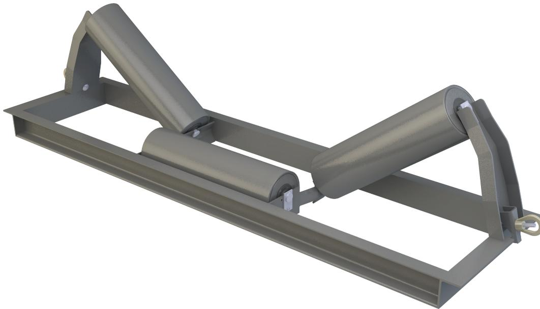
Estos polines están diseñados, principalmente, para ser usados en aplicaciones subterráneas, donde la altura al cielo puede ser bastante limitada. Los polines con cable de acero de PPI poseen un diseño con rodillos centrales de alineación que minimizan la altura del perfil general del conjunto del rodillo. Además, están equipados con una abrazadera universal que permite instalaciones versátiles en aplicaciones con cables de acero o sistemas de rieles rígidos.
