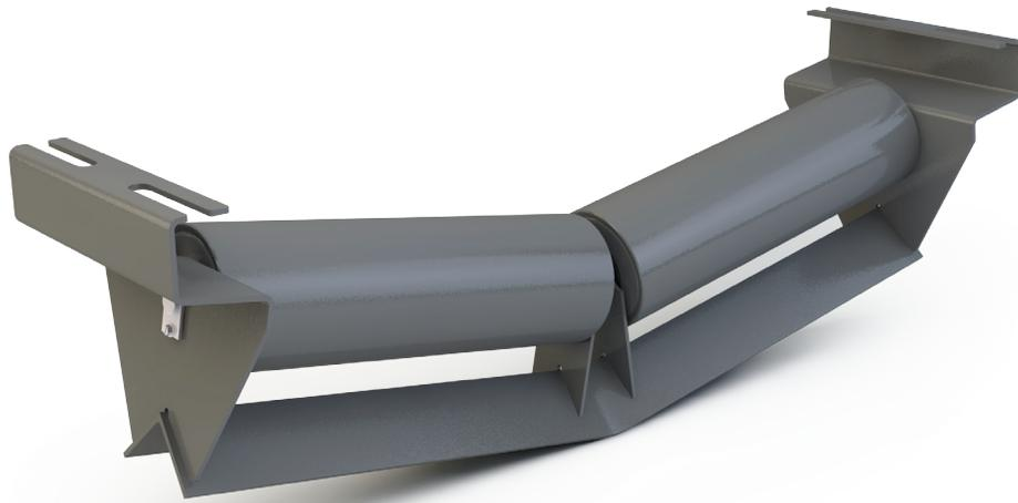
Las estaciones de retorno en V de PPI están disponibles con soportes de caída de 4,5" y 7" y son fabricadas con una configuración de arquetas en V con dos rodillos a 10° que permiten mantener la banda centrada de manera natural por gravedad. El diseño de dos rodillos más cortos permite al usuario instalar rodillos mucho más livianos que las configuraciones tradicionales de un solo rodillo.
