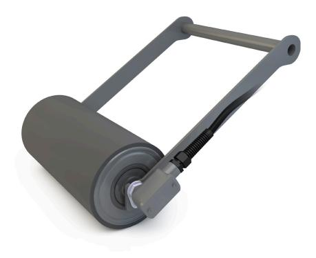
PPI desarrolló y patentó su Smart Roll diseñado para monitorear la velocidad de las bandas. Con la ayuda de un sensor de proximidad protegido dentro del polín reforzado, el Smart Roll™ es capaz de generar una secuencia de pulsos electrónicos que deben ser interpretados por un PLC\* o por nuestro Smart Monitor. Una vez incorporados al sistema de transporte, estos dispositivos de interpretación pueden controlar los sistemas de alarma y detenciones.
