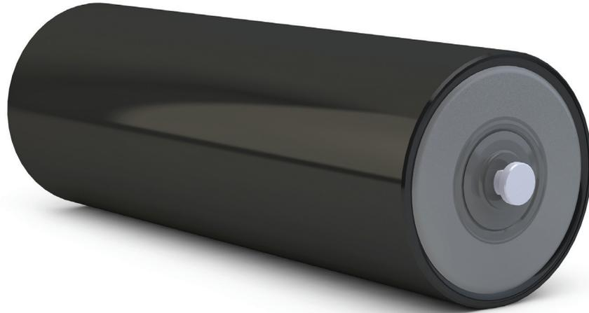
Obtenga las características de repelente de materiales de un rodillo de polímero con la confiabilidad demostrada de los rodillos de acero estándar de PPI. La resistencia al desgaste se extiende instalando una manga plástica sobre el diamante del polín. En muchas aplicaciones, la superficie plástica del rodillo repele el material húmedo y adherente que, en otras circunstancias, se acumularía en un rodillo de acero estándar.
