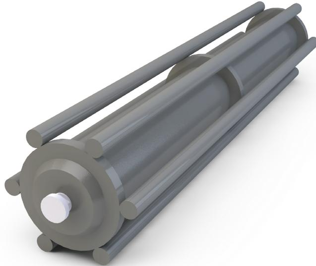
El Rodillo de Retorno con barra batidora de PPI produce un efecto vibratorio de limpieza, dejando caer las acumulaciones de material de la banda transportadora. Al mantener limpia la banda, se minimizan las probabilidades de acumulación de material en los polines de retorno que provocan desviaciones de la banda.
