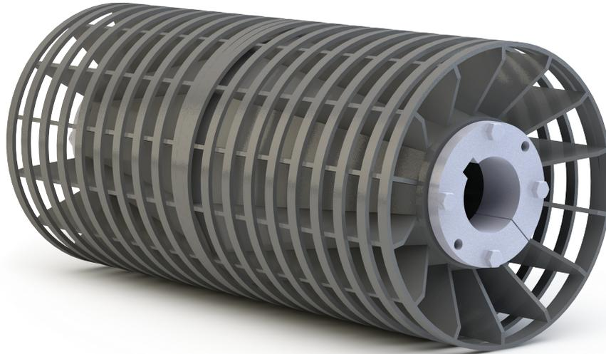
La polea de aletas con espiral y la polea de aletas con espiral PLUS de PPI están formadas por barras planas de acero, enrolladas alrededor de una polea de aletas desde el centro hacia los extremos. Este contacto continuo con la banda transportadora, disminuye los niveles de ruido y vibraciones excesivas, al mismo tiempo que provee un efecto de limpieza creando un punto de expulsión de desechos para que el material salga y no quede atrapado entre la banda transportadora y la polea.
