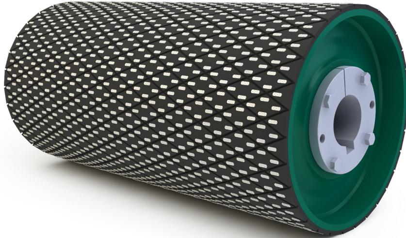
El Revestimiento VEC patentado de PPI comienza con un revestimiento de SBR o de Neopreno que es vulcanizado en caliente sobre la polea. Luego, nuestras losetas de diseño único se insertan en el revestimiento vulcanizado. Esta técnica elimina las juntas que son causa frecuente de fallas. Además, permite aplicar el revestimiento de cerámicas a poleas de hasta 4" de diámetro, algo imposible de lograr con retenes metálicos de revestimiento curados.
