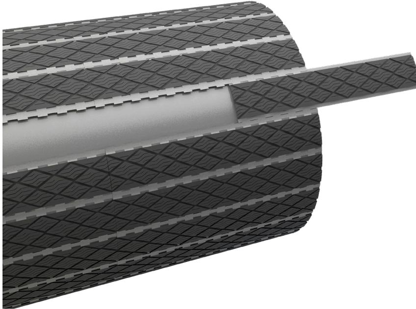
EZ-LAG™ es un revestimiento reemplazable en terreno que va adherido a un respaldo de acero, de 5" de ancho, similar a lo que ocurre con Craft-Lag®. Sin embargo, a diferencia de este último, el respaldo de acero del EZ-LAG tiene perforaciones que le permiten ser adaptado en terreno y ajustarlo a cualquier polea de 12" de diámetro y superiores.
