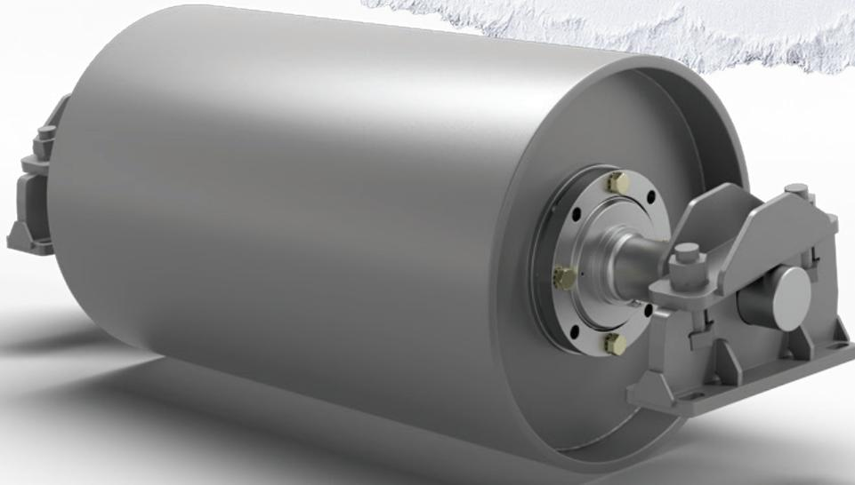
La Polea de Eje Estático SSP (Static Shaft Pulley), es la solución a los problemas en poleas que tienden a presentar fallas en los rodamientos. Estas poleas usan rodamientos de la serie 22200 con la revolucionaria técnica de montaje dentro del cubo de la polea, lo cual permite ofrecer extra protección al rodamiento. Además, este diseño patentado usa un sistema de sellado de taconita que entrega protección adicional impidiendo el ingreso de material contaminante al rodamiento.
