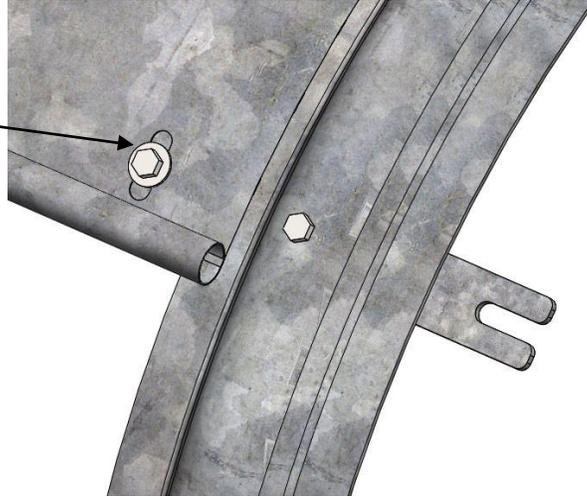
**Figura 14: FIJACIÓN DE CUBIERTA ¾ A LA PLACA DE RETENCIÓN**
