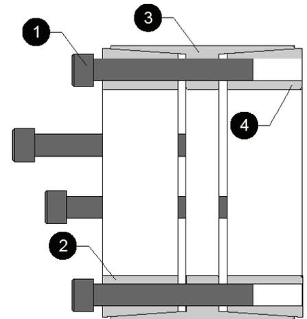
En los casos de instalaciones sujetas a corrosión extrema, las ranuras del elemento de apriete de los collarines ② y ④ así como del elemento central del collarín ③ deben ser selladas con el compuesto de calafateo adecuado o un equivalente. Asimismo, los filetes de empuje también deben ser protegidos contra la corrosión.
